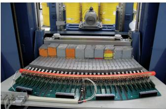
Blick auf Messelektronik mit den fächerartig angeordneten Detektoren im Kollimator, dahinter die <sup>60</sup>Co-Quelle im TK-1000 Behälter
