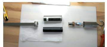
Detektorelement mit Plastikszintillator (links); Mittelstück mit Rohr gegen Streulicht; rechts Endstück mit aufgestecktem Photomultiplier R1166 und Potentiometerschaltung
