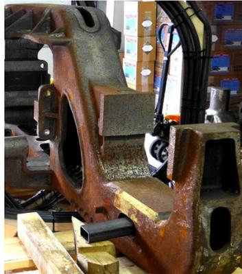
Abb. 3. Prüfobjekt Achsträger eines Güterwagens
