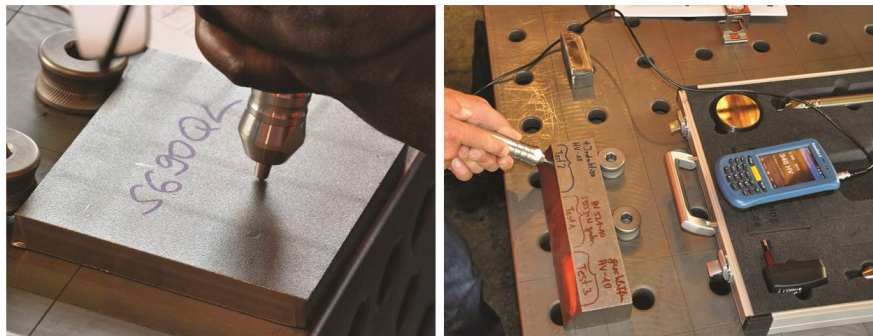
Abb. 7: Messungen an der Laserschnittkante nach unterschiedlicher Oberflächenbearbeitung
