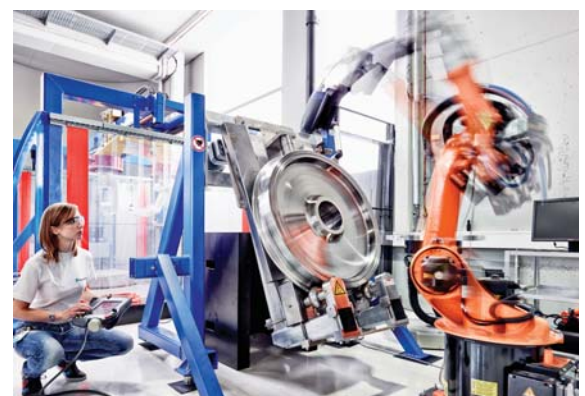
Demonstrator zur Oberflächenrissprüfung mittels induktiv angeregter Thermographie an Eisenbahnradern
