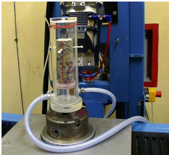
Abb. 8: Prüfkörper in Befeuchtungseinrichtung auf Manipulatorisch
