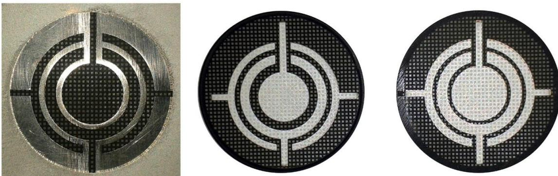
**Abb. 1.** Bedampfungsmaske und fertige Elektrodenstruktur auf PZT-Polymer-Komposit.
