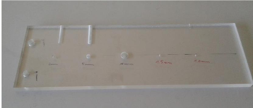
Abb. 6. PMMA-Prüfkörper mit Sacklochbohrungen.
