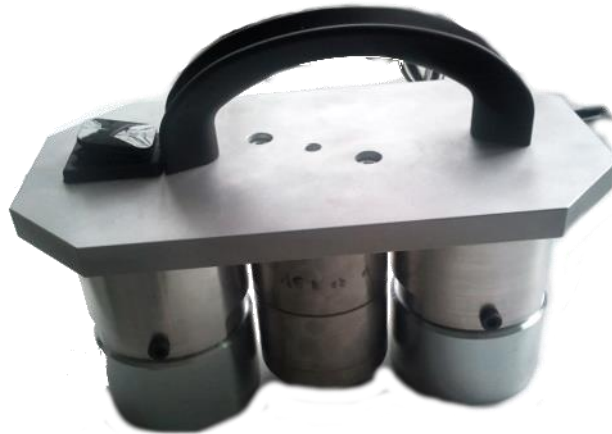
Abbildung 4. Gefertigter Aktor, der für Messungen an Monopiles und Grout-Verbindungen Verwendung findet.
