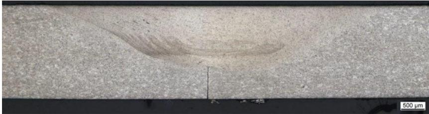
**Abb. 16.** Querschliff der Naht mit unvollständiger Durchschweißung
