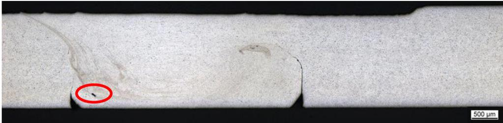
Abb. 14. Querschliff durch den Bereich mit der lokalen Unregelmäßigkeit wurzelseitige Bohrungen, Schlauchpore rot umrandet
