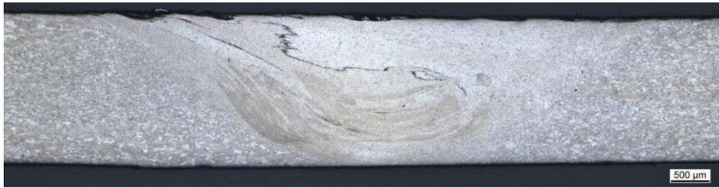
**Abb. 11.** Querschliff durch den Bereich mit der lokalen Unregelmäßigkeit Papiereinschluss
