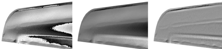
Mangelhafte Verklebung in einem UL-Höhenleitwerk, Messdauer 5s pro Messfeld
