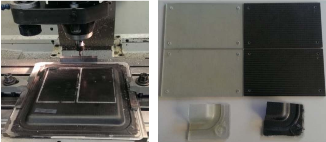
Abb. 1. Fotos der Prüfmuster: (links) Herstellung aus den Laminelementen am Beispiel CFK, (rechts) ebene Platten und komplex geformte Eckstücke aus GFK und CFK.
