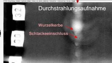
Die Anzeigen sind im zulässigen Rahmen und deckungsgleich mit den Aufnahmen der Durchstrahlungsprüfung, die vor Inbetriebnahme durchgeführt wurde.
