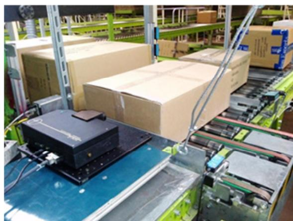
Abb. 4: Mini-Z während des Messvorganges mit Paketanschlag
