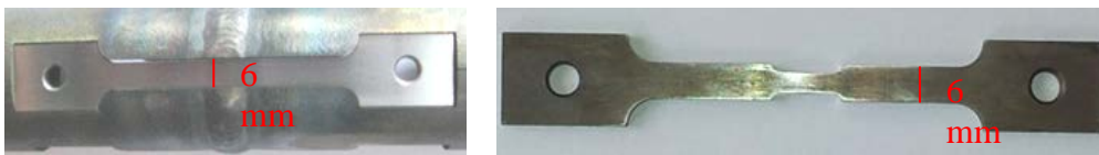
Abb. 3. Probenentnahme aus einer Schweißverbindung, a) Entnahme aus dem Rohr b) Zugprobe nach Taillierung des vollständigen Schweißnaht- und des angrenzenden WEZ-Bereichs
