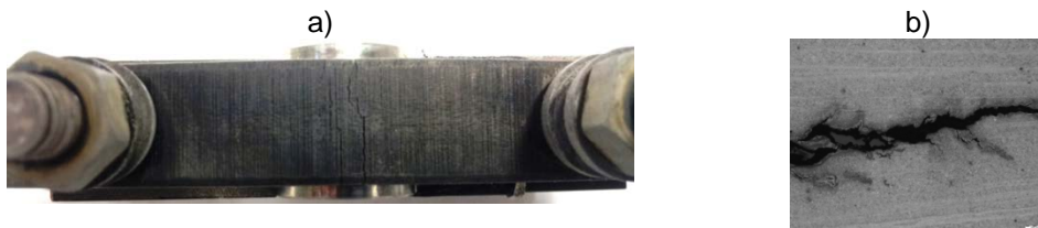
Abb.7. a) Toolox 44 nach 60 min Auslagerungszeit in Salzsäure b) metallografischer Befund
