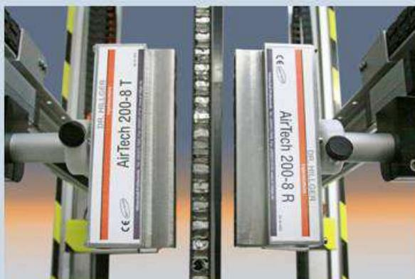
Aktive Ultraschall-Arrays AirTech 200-8 mit acht Elementen
