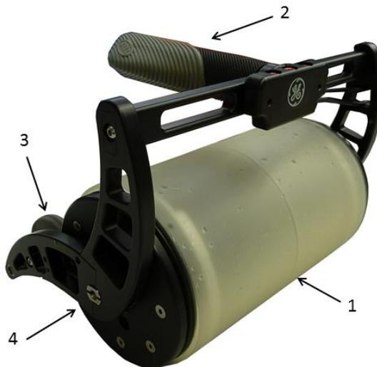
**Abbildung 3:** Das Linear-Array befindet sich in einem gefüllten Reifen aus flexiblem Material (1). Der Handgriff (2) ermöglicht eine leichte Führung des Prüfkopfes wobei die Position des Prüfkopfes durch Stützrollen (3) stabilisiert wird. Der Wegaufnehmer befindet sich auf der Achse des Prüfkopfes (4) und nimmt somit die Positionsdaten ohne Kontakt zum Werkstück auf.
