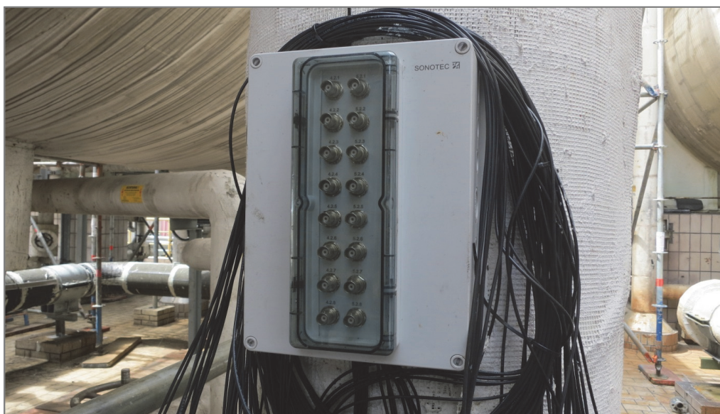
Abb. 3. Anschlusskasten zur Verbindung der Ultraschallprüfköpfe mit dem Prüfgerät
