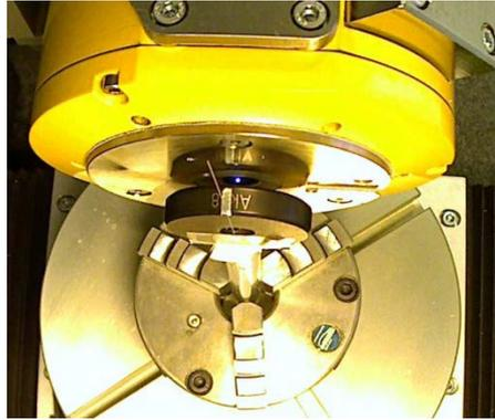
**Abb. 11: Vergleichskörper 1 vor der Röntgenröhre der  $\mu$ CT-Anlage**
