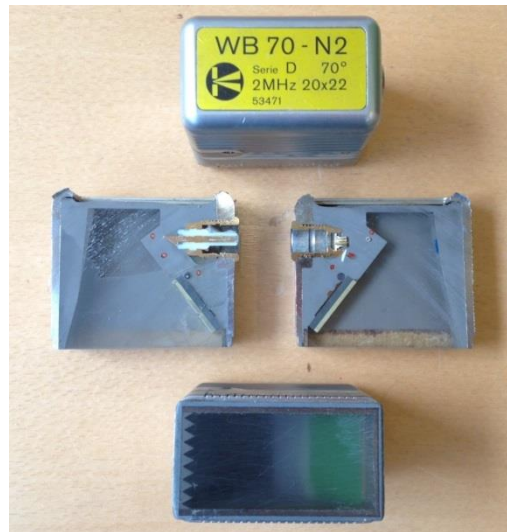
Abb. 2: Aufbau eines 2 MHz Winkelprüfkopfs am Beispiel des WB 70 – N2
