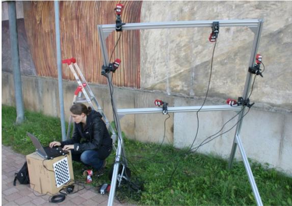
**Bild 1.** Messsystem für die taktile 3D-Erfassung von Rissen
