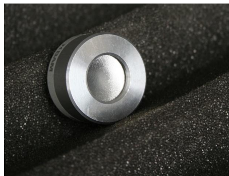
Abb. 2. Fokussierender Luftultraschall-Wandler aus zellulärem Polypropylen.
