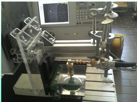
Prüfaufbau mit Linsenantenne, Wabenplatte, Netzwerkanalysator und Verfahreneinrichtung
