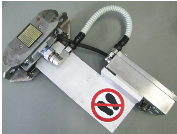
Abb. 6. EMUS-Prüfkopf mit mechanisch entkoppelter Vorortelektronikbox
