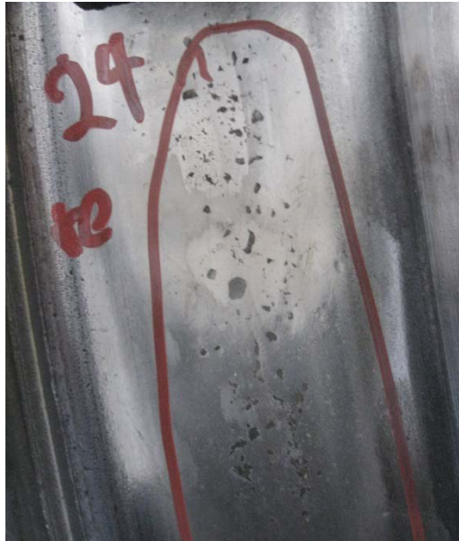
Abb. 9. Achse 24, rechtes Rad: Ausbröckelungen über gesamten Umfang der Lauffläche
